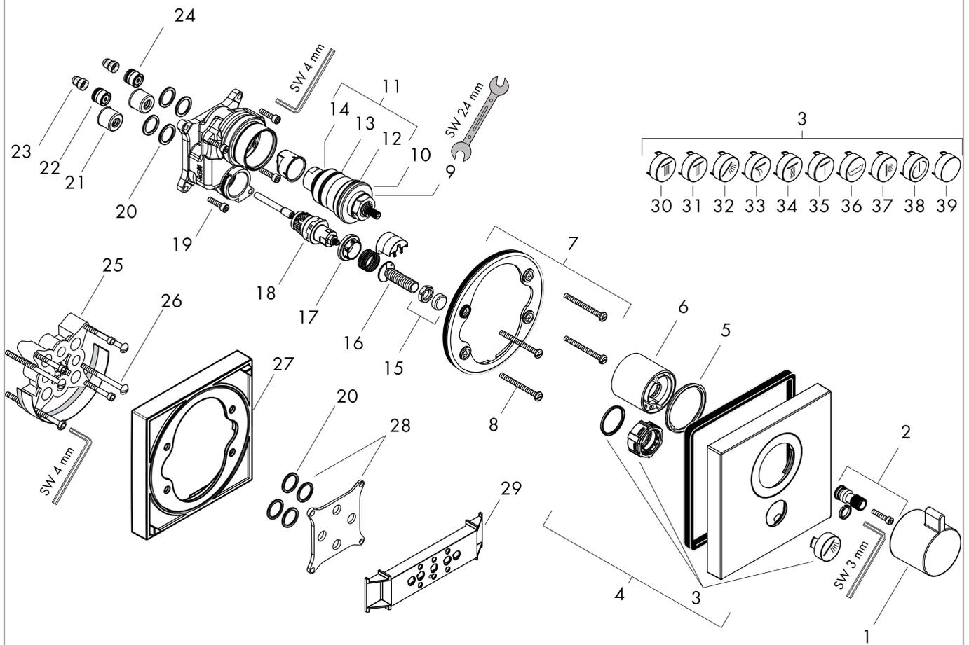
**ShowerSelect****Set de finition pour mitigeur thermostatique encastré haut débit avec une sortie permanente et un robinet d'arrêt**Finition: **Chromé** Numéro d'article: **15761000**
