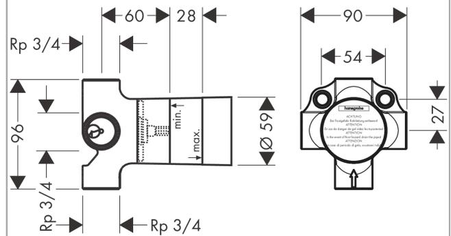
**Corps d'encastrement Quattro pour inverseur à quatre voies**
