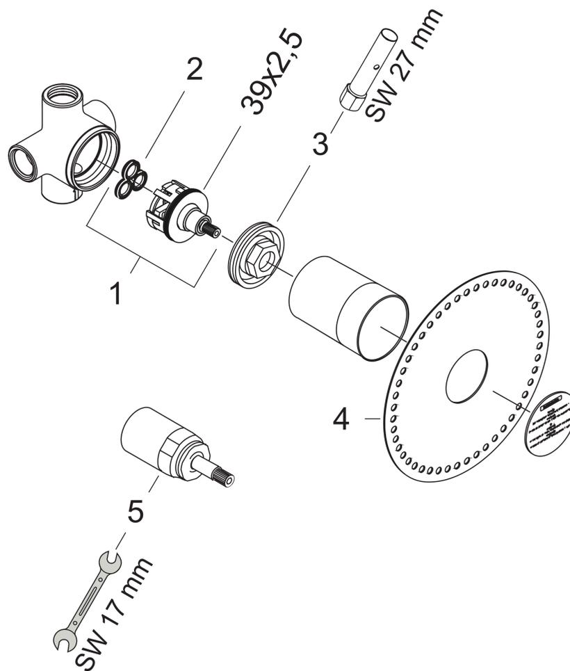
**Corps d'encastrement Quattro pour inverseur à quatre voies**Finition: Numéro d'article: **15930180**
