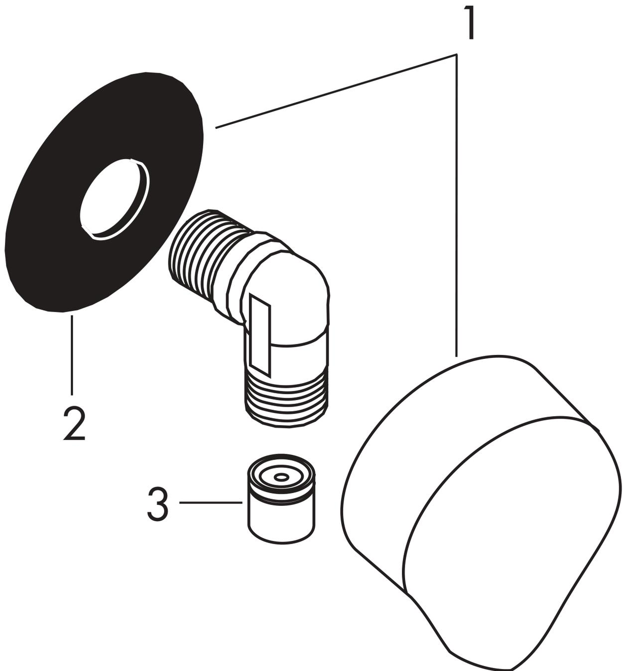
**FixFit****Coude de raccordement**Surfaces: **chromé** Numéro d'article: **27458000**
