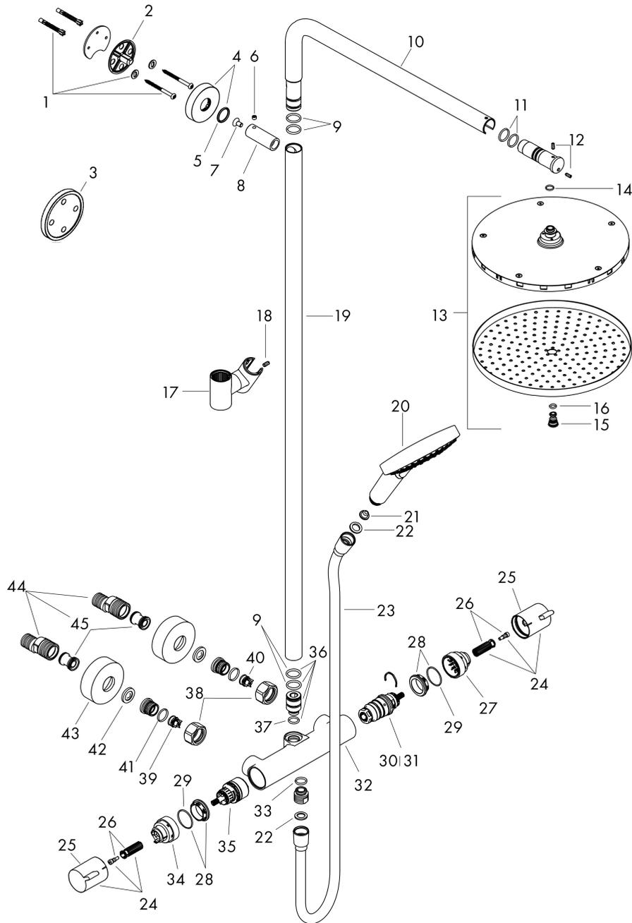
**Raindance Select S****Colonne de douche 240 1jet PowderRain avec mitigeur thermostatique**Finition: **Chromé** Numéro d'article: **27633000**
