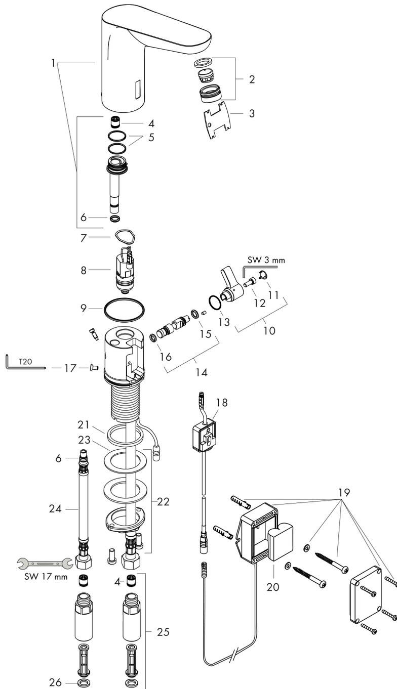
**Focus****Mitigeur de lavabo électronique avec manette de réglage de température sur batterie**Surfaces: **chromé** Numéro d'article: **31171000**
