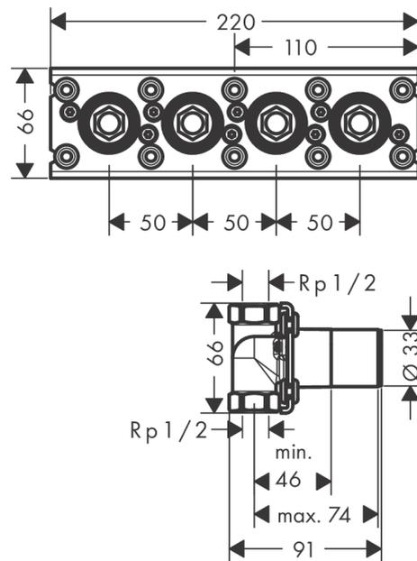
Corps d'encastrement pour mitigeur thermostatique 3 fonctions
