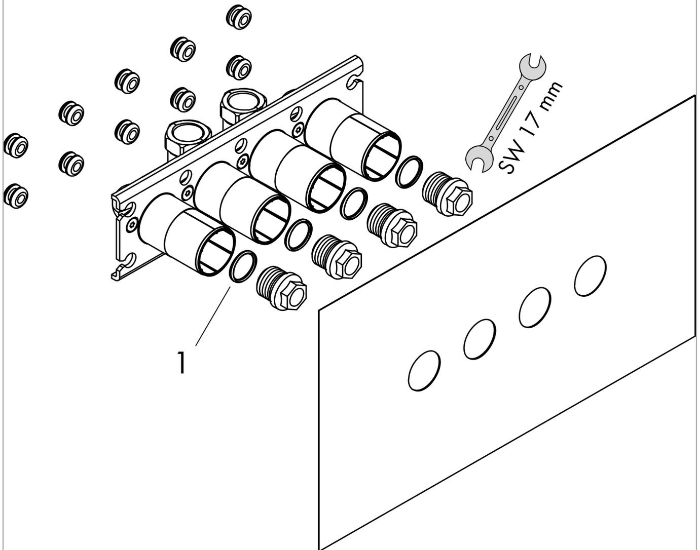
**Corps d'encastrement pour mitigeur thermostatique 3 fonctions**
