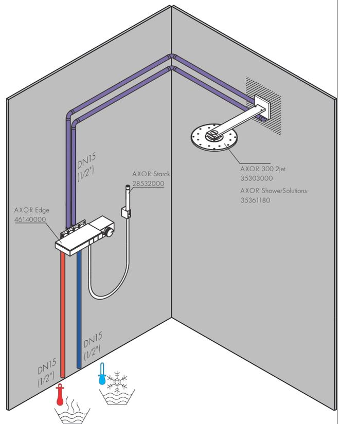
**Corps d'encastrement pour mitigeur thermostatique 3 fonctions**
