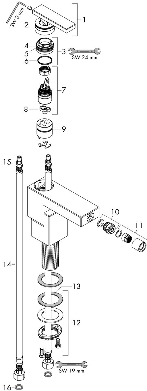
**AXOR Edge****Mitigeur de bidet avec bonde push-open, coupe diamant**Finition: **Chromé** Numéro d'article: **46211000**
