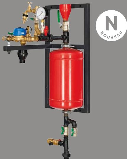
**Le module de remplissage assure la fonction de remplissage de l'installation avec tous les organes nécessaires : pot d'injection, compteur d'appoint, disconnecteur, vannes d'isolement NF, robinet d'arrosage avec clapet HA. Il offre la possibilité à l'installateur de pouvoir y raccorder le vase d'expansion.**
