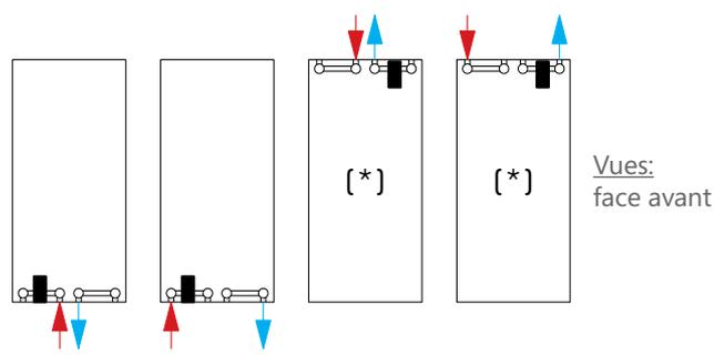
(\*) Lors de l'installation avec raccordement par le haut, il est nécessaire de pouvoir évacuer l'air par les 2 coins supérieurs.
