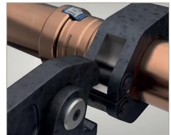
**8. Engagez l'actionneur et vérifiez la profondeur d'insertion**
