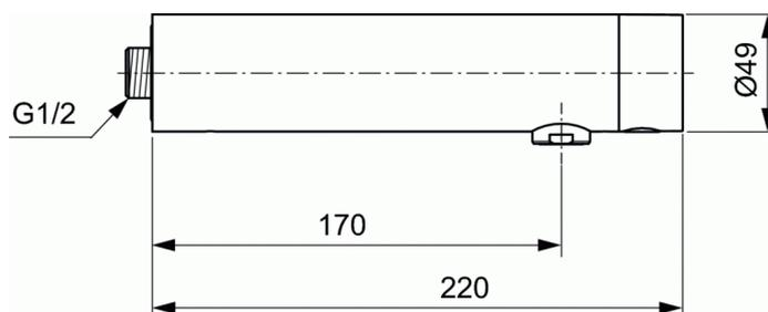
**Bec à détection intégrée pour installation murale - Piles**
