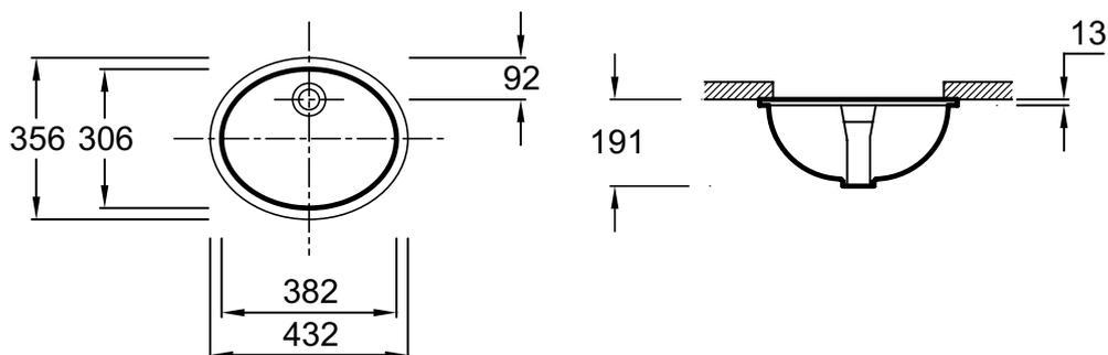
Descriptif CCTP : Vasque à encastrer par-dessous 43 cm. 2209. Collection : CAXTON. DIMENSIONS : 43,20 x 35,60 cm. POIDS : 7,7 kg. MATÉRIAU : Céramique. TYPE D'INSTALLATION : Encastré par-dessous. PERCEMENT ROBINETTERIE : Sans trou. TROP-PLEIN : Avec trou de trop plein.
