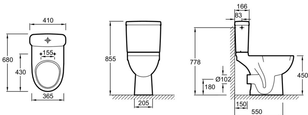
Descriptif CCTP : Cuvette au sol surélevée, sortie horizontale. 4966K. Collection : ODÉON UP. DIMENSIONS : 68 x 36,50 cm. POIDS : 24,2 kg. MATÉRIAU : Céramique. TYPE D'INSTALLATION : Au sol. NORMES ET RÉGLEMENTATIONS : NF. LONGUEUR/PROFONDEUR : Standard. ÉVACUATION : Sortie horizontale. FORME : Arrondie. CONSOMMATION D'EAU : Standard 3/6 L. HAUTEUR : Surélevée/PMR. TYPE DE BRIDE : Ouverte (traditionnelle).
