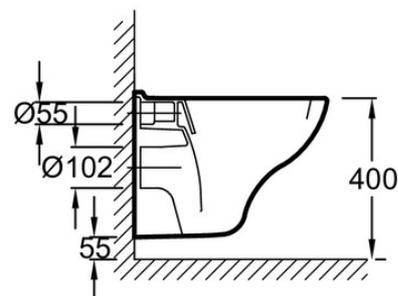
Descriptif CCTP : Cuvette suspendue compacte. E1534. Collection : PATIO. DIMENSIONS : 48 x 35,50 cm. POIDS : 12,8 kg. MATÉRIAU : Céramique. TYPE D'INSTALLATION : Suspendu. NORMES ET RÉGLEMENTATIONS : NF. LONGUEUR/PROFONDEUR : Compact. FORME : Arrondie. CONSOMMATION D'EAU : Standard 3/6 L. HAUTEUR : Réglable de 38 à 50 cm. TYPE DE BRIDE : Ouverte (traditionnelle). GARANTIE DE LA CÉRAMIQUE : 10 ans. Existe aussi en version sans trou d'abattant E1534-Y1.
