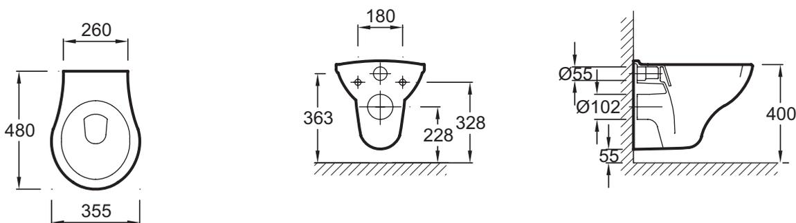
Descriptif CCTP : Cuvette suspendue, sans trou d'abattant. E1534-Y1. Collection : PATIO. DIMENSIONS : 48 x 35,50 cm. POIDS : 12,8 kg. MATÉRIAU : Céramique. TYPE D'INSTALLATION : Suspendu. CONSOMMATION D'EAU : Standard 3/6 L. HAUTEUR : Réglable de 38 à 50 cm. TYPE DE BRIDE : Ouverte (traditionnelle).
