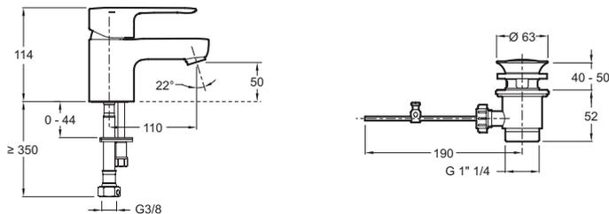
Descriptif CCTP : Mitigeur lavabo. E16027-4. Collection : JULY. POIDS : 1,3 kg. MATÉRIAU : Métal. TYPE D'INSTALLATION : 1 trou. NORMES ET RÉGLEMENTATIONS : NF : I - ECAU : E0 C2 A2 U3 (Ge3) - ACS : 10 ACCLY 113. TYPE : Mitigeur. DÉBIT (L/MN SOUS 3 BARS) : 10 l/mn. RACCORDS : Avec flexibles d'alimentation. MÉCANISME : Cartouche à disques céramique. ECO CONSO : 1. VIDAGE : Avec. GARANTIE MÉCANISME : 5 ans. GARANTIE FINITION : Chrome : 10 ans. Bonde de vidage métal-plastique.
