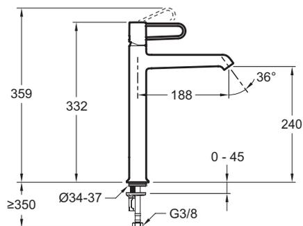
Descriptif CCTP : Mitigeur lavabo - haut - sans vidage. E21031-CP. Collection : ODÉON RIVE GAUCHE. DIMENSIONS : 27,30 x 4,50 cm. POIDS : 1,7 kg. MATÉRIAU : Métal. TYPE D'INSTALLATION : 1 trou. TYPE : Mitigeur. DÉBIT (L/MN SOUS 3 BARS) : 5 l/mn. HAUTEUR TOTALE DU ROBINET (MM) : 332. SAILLIE DU BEC (MM) : 188. RACCORDS : Avec flexibles d'alimentation. MÉCANISME : Cartouche à disques céramique. VIDAGE : Sans. GARANTIE MÉCANISME : 5 ans. GARANTIE FINITION : Chrome 10 ans / Couleur 5 ans.
