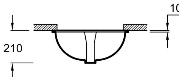
Descriptif CCTP : Vasque à encastrer par-dessous 49 cm. E2210. Collection : CAXTON. DIMENSIONS : 48,90 x 41 cm. POIDS : 9,1 kg. MATÉRIAU : Céramique. TYPED'INSTALLATION : Encastré par-dessous. PERCEMENT ROBINETTERIE : Sans trou. TROP-PLEIN : Avec trou de trop-plein. DURÉE GARANTIE (ANNÉES) : 10. INFORMATIONS COMPLÉMENTAIRES : Bonde et robinetterie non incluses.
