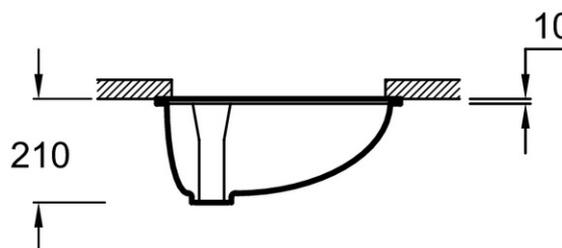
Descriptif CCTP : Vasque à encastrer par-dessous 55 cm. E2211. Collection : CAXTON. DIMENSIONS : 55 x 44 cm. POIDS : 22,9 kg. MATÉRIAU : Céramique. TYPE D'INSTALLATION : Encastré par-dessous. PERCEMENT ROBINETTERIE : Sans trou. TROP-PLEIN : Avec trou de trop-plein. DURÉE GARANTIE (ANNÉES) : 10. INFORMATIONS COMPLÉMENTAIRES : Bonde et robinetterie non incluses.
