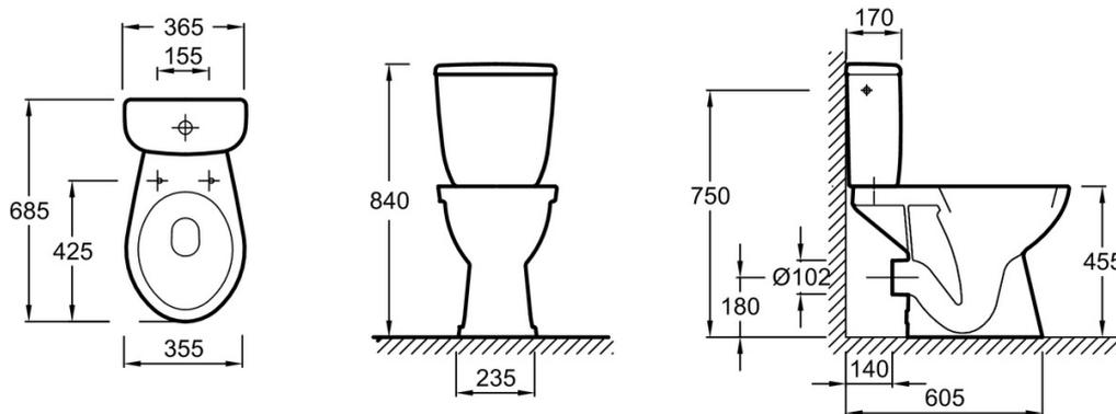
Descriptif CCTP : Pack WC au sol surélevé, sortie horizontale. E22751. Collection : BRIVE. DIMENSIONS : 68,50 x 36,50 cm. POIDS : 30,7 kg. MATÉRIAU : Céramique. TYPE D'INSTALLATION : Au sol. NORMES ET RÉGLEMENTATIONS : NF. ÉVACUATION : Sortie horizontale. FORME : Arrondie. CONSOMMATION D'EAU : Standard 3/6 L. HAUTEUR : Surélevée/PMR. TYPE DE BRIDE : Ouverte (traditionnelle). GARANTIE DE LA CÉRAMIQUE : 10 ans. GARANTIE DE L'ABATTANT : 2 ans. GARANTIE DU MÉCANISME : 2 ans.
