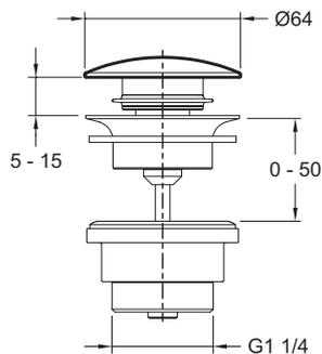
Descriptif CCTP : Bonde de vidage. E30536. Collection : Hors collection. POIDS : 1 kg. MATÉRIAU : Laiton. La couleur "Noir mat" est un revêtement Epoxy.. La bonde s'ouvre ou se ferme en appuyant sur le clapet..
