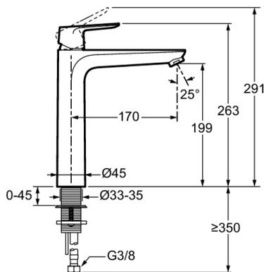
Descriptif CCTP : Mitigeur lavabo L, sans vidage. E35666-4ND. Collection : JULY+. DIMENSIONS : 20,50 x 26,30 cm. POIDS : 1,6 kg. MATÉRIAU : Laiton. TYPE D'INSTALLATION : 1 trou. NORMES ET RÉGLEMENTATIONS : ACS : 24 ACC LY 252. TYPE DE FLEXIBLE : Flexibles revêtus de matière polymère. TYPE : Mitigeur. DÉBIT (L/MN SOUS 3 BAR) : 5 l/min. HAUTEUR TOTALE DU ROBINET (MM) : 263. SAILLIE DU BEC (MM) : 170. ECO CONSO : oui. GARANTIE MÉCANISME : 5 ans. DURÉE GARANTIE (ANNÉES) : 5.
