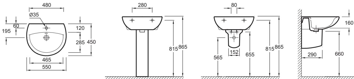
Descriptif CCTP : Lavabo 55 cm. E4158. Collection : PATIO. DIMENSIONS : 55 x 45 cm. POIDS : 12,9 kg. MATÉRIAU : Céramique. TYPE D'INSTALLATION : Autoportant. FIXATIONS : Par 2 goujons non fournis. PERCEMENT ROBINETTERIE : 1 trou. CONFIGURATION : Standard. INFOS COMPLÉMENTAIRES : Robinetterie non incluse.
