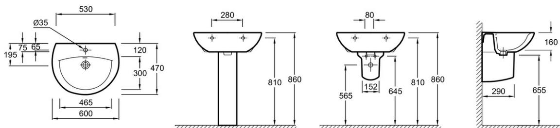
Descriptif CCTP : Lavabo 60 cm. E4159. Collection : PATIO. DIMENSIONS : 60 x 47 cm. POIDS : 13,8 kg. MATÉRIAU : Céramique. TYPE D'INSTALLATION : Autoportant. NORMES ET RÉGLEMENTATIONS : NF ; FDES. FIXATIONS : Par 2 goujons non fournis. PERCEMENT ROBINETTERIE : 1 trou. TROP-PLEIN : Avec trou de trop plein. DURÉE GARANTIE (ANNÉES) : 10. INFORMATIONS COMPLÉMENTAIRES : Bonde et robinetterie non incluses.
