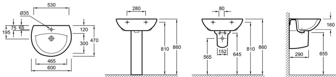
Descriptif CCTP : Lavabo 60 cm. E4159-X5. Collection : PATIO. DIMENSIONS : 60 x 47 cm. POIDS : 13,8 kg. MATÉRIAU : Céramique. TYPE D'INSTALLATION : Autoportant. NORMES ET RÉGLEMENTATIONS : NF ; FDES. CONFIGURATION : Standard. PERCEMENT ROBINETTERIE : 1 trou. MEULÉ/NON-MEULÉ : Non meulé. TROP-PLEIN : Sans trou de trop-plein. NOMBRE DE VASQUES : 1 cuve. DURÉE GARANTIE (ANNÉES) : 10. INFORMATIONS COMPLÉMENTAIRES : Bonde et robinetterie non incluses.
