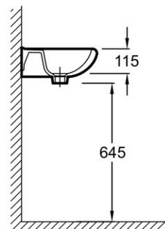
Descriptif CCTP : Lave-mains 45 cm. E4338. Collection : BRIVE. DIMENSIONS : 45 x 35 cm. POIDS : 8,2 kg. MATÉRIAU : Céramique. TYPE D'INSTALLATION : Autoportant. SIPHON RECOMMANDÉ : 1. FIXATIONS : Par goujon. PERCEMENT ROBINETTERIE : 1 trou. TROP-PLEIN : Avec trou de trop-plein. DURÉE GARANTIE (ANNÉES) : 10. INFORMATIONS COMPLÉMENTAIRES : Bonde et robinetterie non incluses.
