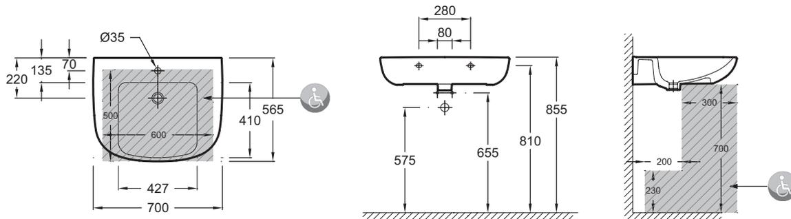
Descriptif CCTP : Lavabo PMR 70 cm. E4495-X5. Collection : ODÉON UP. DIMENSIONS : 70 x 56,50 cm. POIDS : 19,5 kg. MATÉRIAU : Céramique. TYPE D'INSTALLATION : Autoportant. PERCEMENT ROBINETTERIE : 1 trou. CONFIGURATION : Standard. TROP-PLEIN : Sans trou de trop-plein. NOMBRE DE VASQUES : 1 cuve. INFOS COMPLÉMENTAIRES : robinetterie non incluse.
