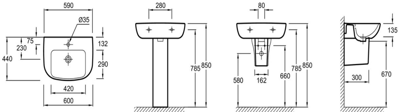
Descriptif CCTP : Lavabo 60 cm. E4700. Collection : ODÉON UP. DIMENSIONS : 60 x 44 cm. POIDS : 15,4 kg. MATÉRIAU : Céramique. TYPE D'INSTALLATION : Autoportant. NORMES ET RÉGLEMENTATIONS : NF ; FDES. CONFIGURATION : Compact. PERCEMENT ROBINETTERIE : 1 trou. TROP-PLEIN : Avec trou de trop-plein. NOMBRE DE VASQUES : 1 cuve. ROBINETTERIE CONSEILLÉE : Aleo. DURÉE GARANTIE (ANNÉES) : 10. INFORMATIONS COMPLÉMENTAIRES : Bonde et robinetterie non incluses.
