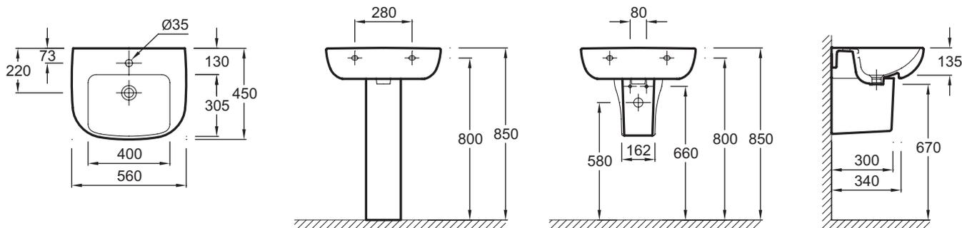
Descriptif CCTP : Lavabo 56 cm. E4737. Collection : ODÉON UP. DIMENSIONS : 56 x 45 cm. POIDS : 15,2 kg. MATÉRIAU : Céramique. TYPE D'INSTALLATION : Autoportant. PERCEMENT ROBINETTERIE : 1 trou. CONFIGURATION : Standard. TROP-PLEIN : Avec trou de trop-plein. ROBINETTERIE CONSEILLÉE : Aleo. INFOS COMPLÉMENTAIRES : Robinetterie non incluse.
