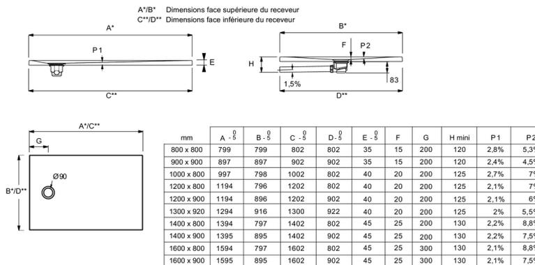
Descriptif CCTP : Receveur 90 x 90 cm. E62102-F. Collection : AEROBLOC. DIMENSIONS : 90 x 90 x 3,30 cm. POIDS : 12 kg. MATÉRIAU : Aerobloc. TYPE D'INSTALLATION : Surélevé, posé ou encastré. ANTIDÉRAPANT : Oui. FORME : Carré. DIAMÈTRE DE BONDE (CM) : 9. MOTIF DE SURFACE : Antidérapant. NIVEAU D'ADHÉRENCE : PN24 selon la norme NF. LIVRÉ AVEC BONDE : non. DURÉE GARANTIE (ANNÉES) : 10. MATÉRIAU AEROBLOC : sandwich très solide et léger composé de fibres de verre, de résine et de PET recyclé.
