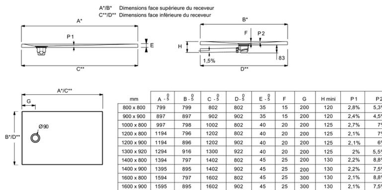
Descriptif CCTP : Receveur 120x90 cm. E62105-F. Collection : AEROBLOC. DIMENSIONS : 120 x 90 x 3,80 cm. POIDS : 15 kg. MATÉRIAU : Aerobloc. TYPE D'INSTALLATION : Surélevé, posé ou encastré. ANTIDÉRAPANT : Oui. DIAMÈTRE DE BONDE (CM) : 9. MOTIF DE SURFACE : Antidérapant. LIVRÉ AVEC BONDE : non. DURÉE GARANTIE (ANNÉES) : 10. MATÉRIAU AEROBLOC : sandwich très solide et léger composé de fibres de verre, de résine et de PET recyclé.
