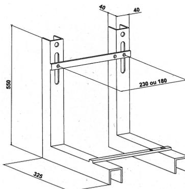
Descriptif CCTP : Bâti-support seul. E6510. Collection : Hors collection. DIMENSIONS : 27 x 32,50 cm. POIDS : 6 kg. MATÉRIAU : N/A. TYPE D'INSTALLATION : Autoportant ou en applique sur mur ou en cloison légère ou en gaine technique. TYPE DE SUPPORT : Bâti-support mural. Nécessite un mur porteur.
