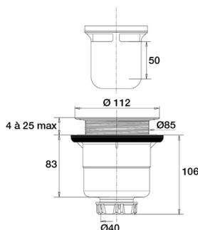
Descriptif CCTP : Bonde verticale sans capot. E6760. Collection : Hors collection. MATÉRIAU : N/A. DIAMÈTRE DE BONDE (CM) : 9. TYPE D'ACCESSOIRE : Bonde. DURÉE GARANTIE (ANNÉES) : 2. DATE DE LANCEMENT : 2023-01-02 00:00:00. CAPOT : non livré. DÉBIT : 45 l/mn. SORTIE : 40 mm à visser ou à coller. GARDE D'EAU : 50 mm.
