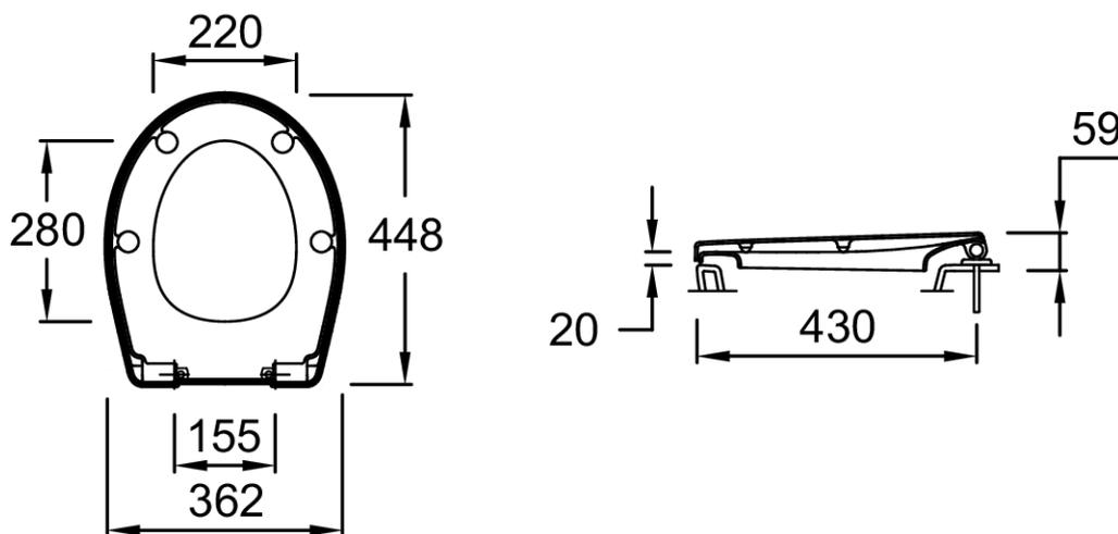
Descriptif CCTP : Abattant thermodur à descente progressive. E70021. Collection : PATIO. POIDS : 1,9 kg. MATÉRIAU : Thermodur. TYPE D'ABATTANT : Standard. ABATTANT : A descente progressive et déclinable. CHARNIÈRES : Métal inox. ABATTANT ANTIBACTÉRIEN : Non. GARANTIE DE L'ABATTANT : 2 ans. CONDITIONNEMENT : 1 colis.
