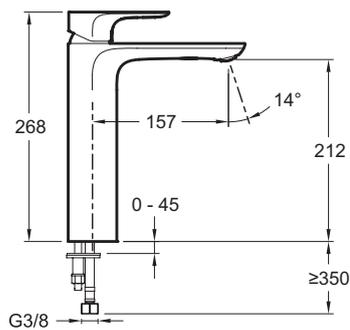
Descriptif CCTP : Mitigeur lavabo - modèle haut - avec système breveté 5l35". E72299-4. Collection : ALEO. POIDS : 1,7 kg. MATÉRIAU : Métal. TYPE D'INSTALLATION : 1 trou. TYPE : Mitigeur. DÉBIT (L/MN SOUS 3 BARS) : 5 l/mn. HAUTEUR TOTALE DU ROBINET (MM) : 268. SAILLIE DU BEC (MM) : 157. RACCORDS : Avec flexibles d'alimentation. MÉCANISME : Cartouche à disques céramique. VIDAGE : Sans. GARANTIE MÉCANISME : 5 ans. TYPE DE FLEXIBLE : PEX.
