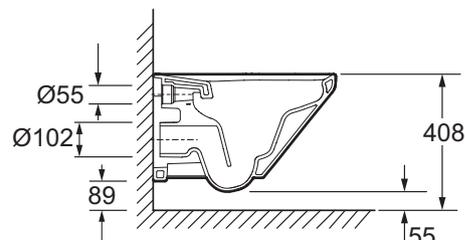
Descriptif CCTP : Cuvette suspendue SANS BRIDE. E77725. Collection : MODERN LIFE. DIMENSIONS : 54 x 36 cm. MATÉRIAU : Céramique. TYPE D'INSTALLATION : Suspendu. CONSOMMATION D'EAU : Standard 3/6 L. HAUTEUR : Standard. TYPE DE BRIDE : Sans bride. MÉCANISME DE CHASSE : double chasse. GARANTIE DE LA CÉRAMIQUE : 10 ans. CONDITIONNEMENT : Carton. FIXATION DE LA CUVETTE : invisibles.
