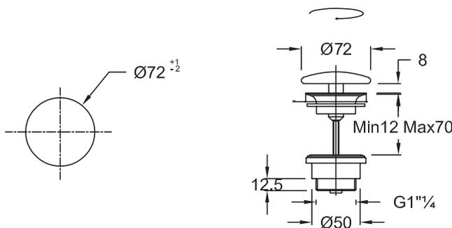
Descriptif CCTP : Bonde de vidage à débordement. E78263. Collection : Hors collection. POIDS : 0,4 kg. MATÉRIAU : N/A. TYPE D'ACCESSOIRE : Bonde de vidage. CONFIGURATION : A débordement.
