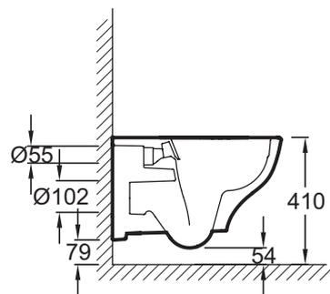
Descriptif CCTP : Cuvette suspendue SANS BRIDE. EDE101. Collection : STRUKTURA. DIMENSIONS : 54 x 34 cm. POIDS : 25 kg. MATÉRIAU : Céramique. TYPE D'INSTALLATION : Suspendu. CONSOMMATION D'EAU : 2,6/4 L et 3/6 L. HAUTEUR : Confort. TYPE DE BRIDE : Sans bride. GARANTIE DE LA CÉRAMIQUE : 10 ans. CONDITIONNEMENT : 1 colis.
