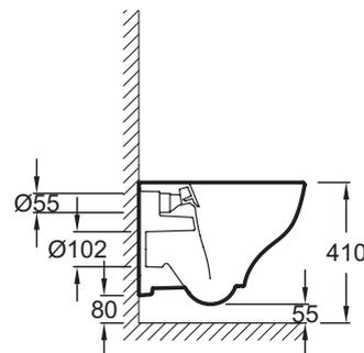
Descriptif CCTP : Cuvette suspendue SANS BRIDE. EDF101. Collection : STRUKTURA. DIMENSIONS : 48 x 34 cm. POIDS : 19 kg. MATÉRIAU : Céramique. TYPE D'INSTALLATION : Suspendu. NORMES ET RÉGLEMENTATIONS : NF ; FDES. CONSOMMATION D'EAU : 2,6/4 L et 3/6 L. HAUTEUR : Confort. TYPE DE BRIDE : Sans bride. MÉCANISME DE CHASSE : Double chasse. GARANTIE DE LA CÉRAMIQUE : 10 ans. CONDITIONNEMENT : 1 colis.
