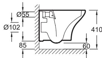
Descriptif CCTP : Cuvette suspendue SANS BRIDE compacte. EDK102. Collection : NOUVELLE VAGUE. DIMENSIONS : 48 x 39 cm. POIDS : 20 kg. MATÉRIAU : Céramique. TYPE D'INSTALLATION : Suspendu. CONSOMMATION D'EAU : 2,6/4 L et 3/6 L. HAUTEUR : Standard. TYPE DE BRIDE : Sans bride. GARANTIE DE LA CÉRAMIQUE : 10 ans. FIXATION DE LA CUVETTE : Invisibles.
