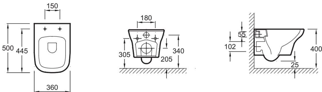
Descriptif CCTP : Cuvette suspendue SANS BRIDE. EDM102. Collection : VOX. DIMENSIONS : 50 x 36 cm. POIDS : 21,2 kg. MATÉRIAU : Céramique. TYPE D'INSTALLATION : Suspendu. CONSOMMATION D'EAU : Standard 3/6 L. TYPE DE BRIDE : Sans bride. MÉCANISME DE CHASSE : Double chasse. GARANTIE DE LA CÉRAMIQUE : 10 ans. FIXATION DE LA CUVETTE : Invisibles.
