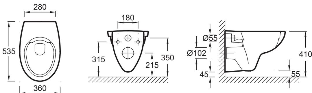
Descriptif CCTP : Cuvette suspendue SANS BRIDE, sans trou d'abattant. EDV001. Collection : PATIO. DIMENSIONS : 53,50 x 36 cm. POIDS : 15 kg. MATÉRIAU : Céramique. TYPE D'INSTALLATION : Suspendu. NORMES ET RÉGLEMENTATIONS : NF. CONSOMMATION D'EAU : Standard 3/6 L. HAUTEUR : Standard. TYPE DE BRIDE : Sans bride. GARANTIE DE LA CÉRAMIQUE : 10 ans. Existe en version avec trou d'abattant.
