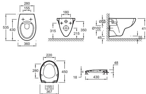
Descriptif CCTP : Pack WC suspendu SANS BRIDE. EDV114. Collection : PATIO. DIMENSIONS : 53,50 x 36 cm. POIDS : 15 kg. MATÉRIAU : Céramique. TYPE D'INSTALLATION : Suspendu. CONSOMMATION D'EAU : Standard 3/6 L. HAUTEUR : Standard. TYPE DE BRIDE : Sans bride. MATÉRIAU DE L'ABATTANT : Thermodur. CHARNIÈRES : métal. GARANTIE DE LA CÉRAMIQUE : 10 ans. GARANTIE DE L'ABATTANT : 2 ans. CONDITIONNEMENT : 1 colis. FIXATION DE LA CUVETTE : Cachées. LIVRÉ AVEC : Abattant thermodur, charnières métal E4303-00.
