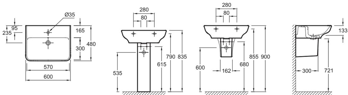
Descriptif CCTP : Lavabo 60 cm, non meulé. EGD111. Collection : STRUKTURA. DIMENSIONS : 60 x 48 cm. POIDS : 18 kg. MATÉRIAU : Céramique. TYPE D'INSTALLATION : Autoportant. NORMES ET RÉGLEMENTATIONS : NF. PERCEMENT ROBINETTERIE : 1 trou. CONFIGURATION : Standard. MEULÉ/NON-MEULÉ : Non meulé. TROP-PLEIN : Avec trou de trop-plein. INFOS COMPLÉMENTAIRES : Robinetterie non incluse.
