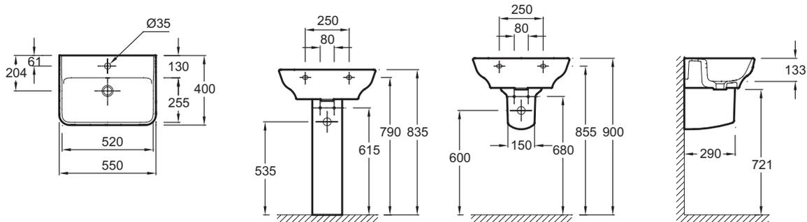
Descriptif CCTP : Lavabo 55 cm, non meulé. EGE111. Collection : STRUKTURA. DIMENSIONS : 55 x 40 cm. POIDS : 14,7 kg. MATÉRIAU : Céramique. TYPE D'INSTALLATION : Autoportant. NORMES ET RÉGLEMENTATIONS : NF. PERCEMENT ROBINETTERIE : 1 trou. CONFIGURATION : Standard. MEULÉ/NON-MEULÉ : Non meulé. TROP-PLEIN : Avec trou de trop-plein. NOMBRE DE VASQUES : 1 cuve. INFOS COMPLÉMENTAIRES : Robinetterie non incluse.
