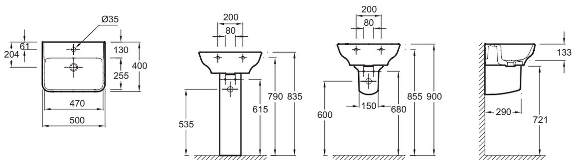
Descriptif CCTP : Lavabo 50 cm, non meulé. EGF111. Collection : STRUKTURA. DIMENSIONS : 50 x 40 cm. POIDS : 13,6 kg. MATÉRIAU : Céramique. TYPE D'INSTALLATION : Autoportant. PERCEMENT ROBINETTERIE : 1 trou. CONFIGURATION : Standard. MEULÉ/NON-MEULÉ : Non meulé. TROP-PLEIN : Avec trou de trop-plein. NOMBRE DE VASQUES : 1 cuve. INFOS COMPLÉMENTAIRES : Robinetterie non incluse.
