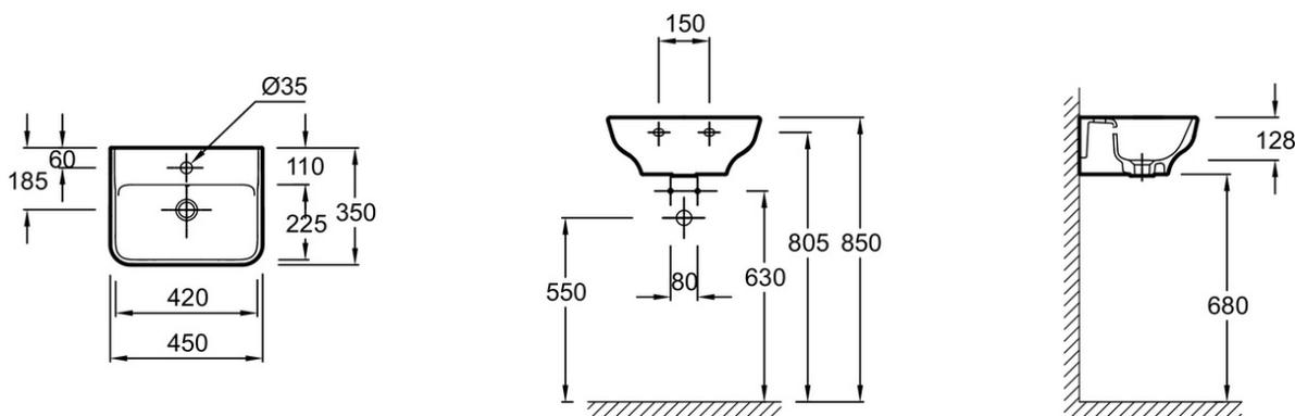
Descriptif CCTP : Lave-mains 45 cm. EGH111. Collection : STRUKTURA. DIMENSIONS : 45 x 35 cm. POIDS : 10 kg. MATÉRIAU : Céramique. TYPE D'INSTALLATION : Autoportant. NORMES ET RÉGLEMENTATIONS : NF. SIPHON RECOMMANDÉ : Non. PERCEMENT ROBINETTERIE : 1 trou. MEULÉ/NON-MEULÉ : Non meulé. TROP-PLEIN : Avec trou de trop-plein. DURÉE GARANTIE (ANNÉES) : 10. INFORMATIONS COMPLÉMENTAIRES : Robinetterie non incluse.
