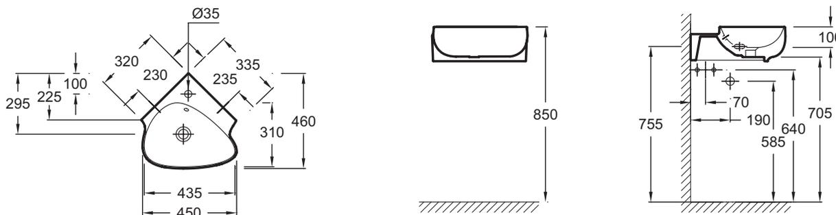
Descriptif CCTP : Lave-mains d'angle 45 cm. EGL112. Collection : NOUVELLE VAGUE. DIMENSIONS : 45 x 46 cm. POIDS : 12 kg. MATÉRIAU : Céramique. TYPE D'INSTALLATION : Autoportant. PERCEMENT ROBINETTERIE : 1 trou. CONFIGURATION : Angle. TROP-PLEIN : Avec trou de trop-plein. LIVRÉ AVEC : Clapet de bonde. ROBINETTERIE CONSEILLÉE : Nouvelle Vague. INFOS COMPLÉMENTAIRES : Robinetterie non incluse.
