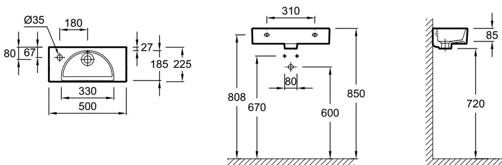
Descriptif CCTP : Lave-mains 50 cm. EG0112-55. Collection : ODÉON RIVE GAUCHE. DIMENSIONS : 50 x 22,50 cm. POIDS : 8 kg. MATÉRIAU : Céramique. TYPE D'INSTALLATION : Autoportant ou peut être monté sur un meuble spécifique. PERCEMENT ROBINETTERIE : 1 trou. CONFIGURATION : Gauche. NOMBRE DE VASQUES : 1 cuve. ROBINETTERIE CONSEILLÉE : Odéon Rive Gauche. INFOS COMPLÉMENTAIRES : Robinetterie non incluse.
