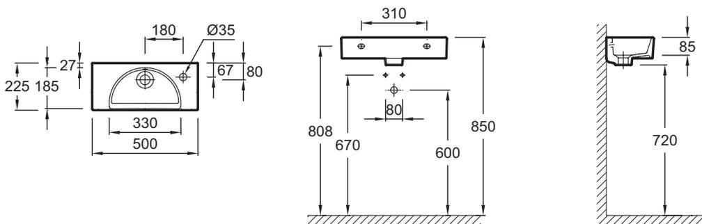
Descriptif CCTP : Lave-mains 50 cm. EG0112-56. Collection : ODÉON RIVE GAUCHE. DIMENSIONS : 50 x 22,50 cm. POIDS : 8 kg. MATÉRIAU : Céramique. TYPE D'INSTALLATION : Autoportant ou peut être monté sur un meuble spécifique. PERCEMENT ROBINETTERIE : 1 trou. CONFIGURATION : Droite. NOMBRE DE VASQUES : 1 cuve. ROBINETTERIE CONSEILLÉE : Odéon Rive Gauche. INFOS COMPLÉMENTAIRES : Robinetterie non incluse.
